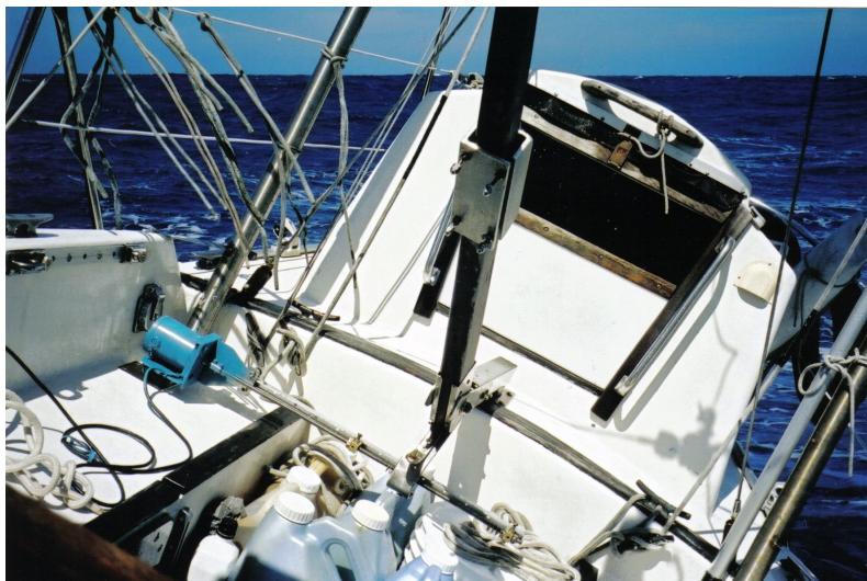
Amatorsko wykonany siłownik autopilota bardzo dobrze trzyma zaplanowany kurs magnetyczny.
