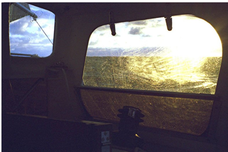
Szyby pokryte solą z wody morskiej w znacznym stopniu ograniczają widoczność.
