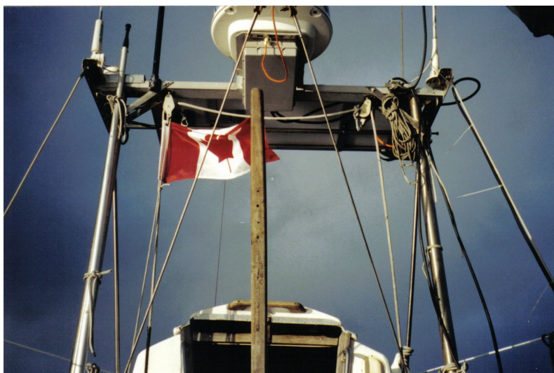
Rama rufowa na której zamontowany jest między innymi panel baterii słonecznych i bandera. Jeżeli jest ona cała wyprostowana, to znaczy że wieje wiatr o sile 5-ciu stopni w skali Beauforta.
