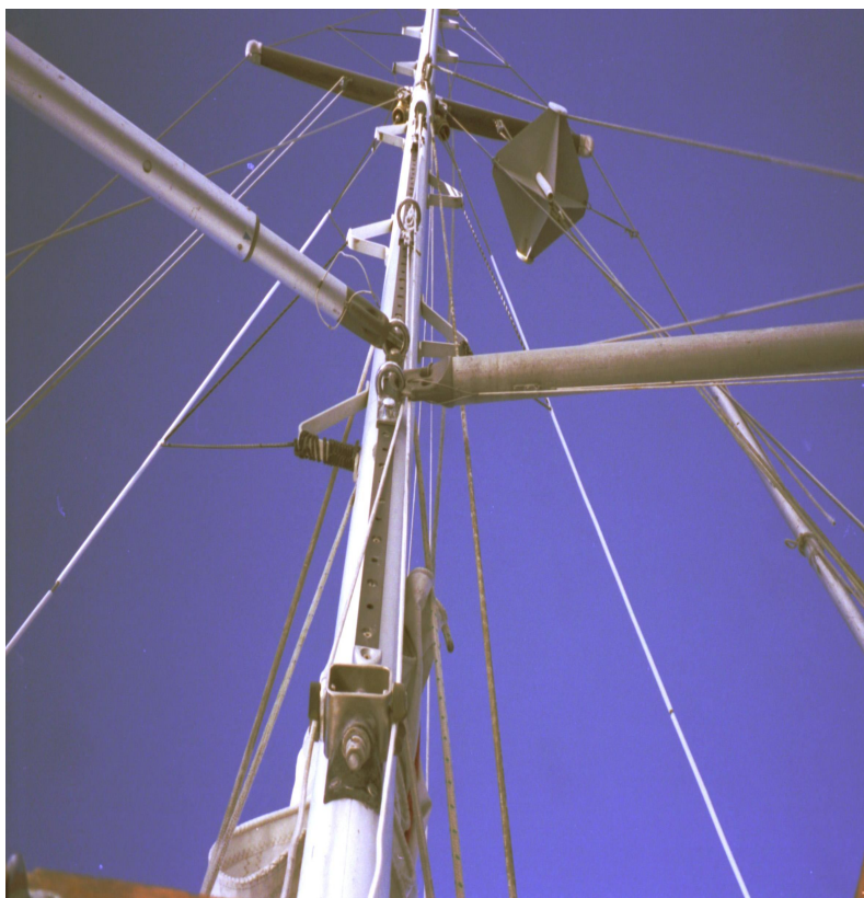
Maszt ze stopniami do wchodzenia.
