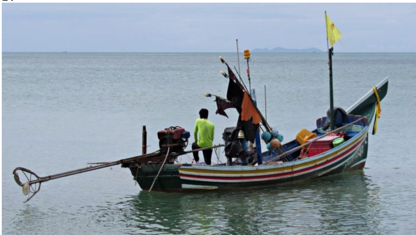
Moją uwagę zwróciły silniki, z długimi wałami napędowymi i śrubą na końcu. Pamiętam z dawnych czasów w Polsce takie silniczki kajakowe „Warta”, które używaliśmy na żaglowych omegach, płynąc na Mazury pod prąd Narwi i Pisy.
