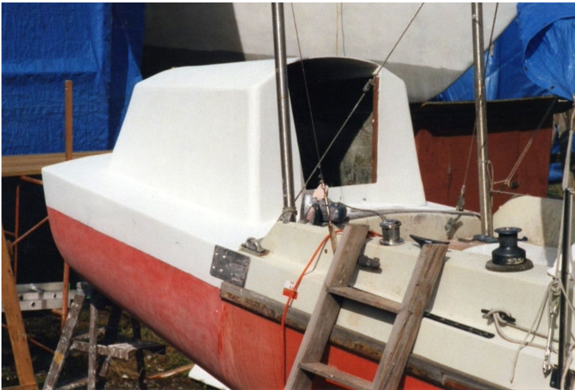
Burta, pokład i nadbudówka nowej sekcji pomalowane. Pozostały prace wykończeniowe.
