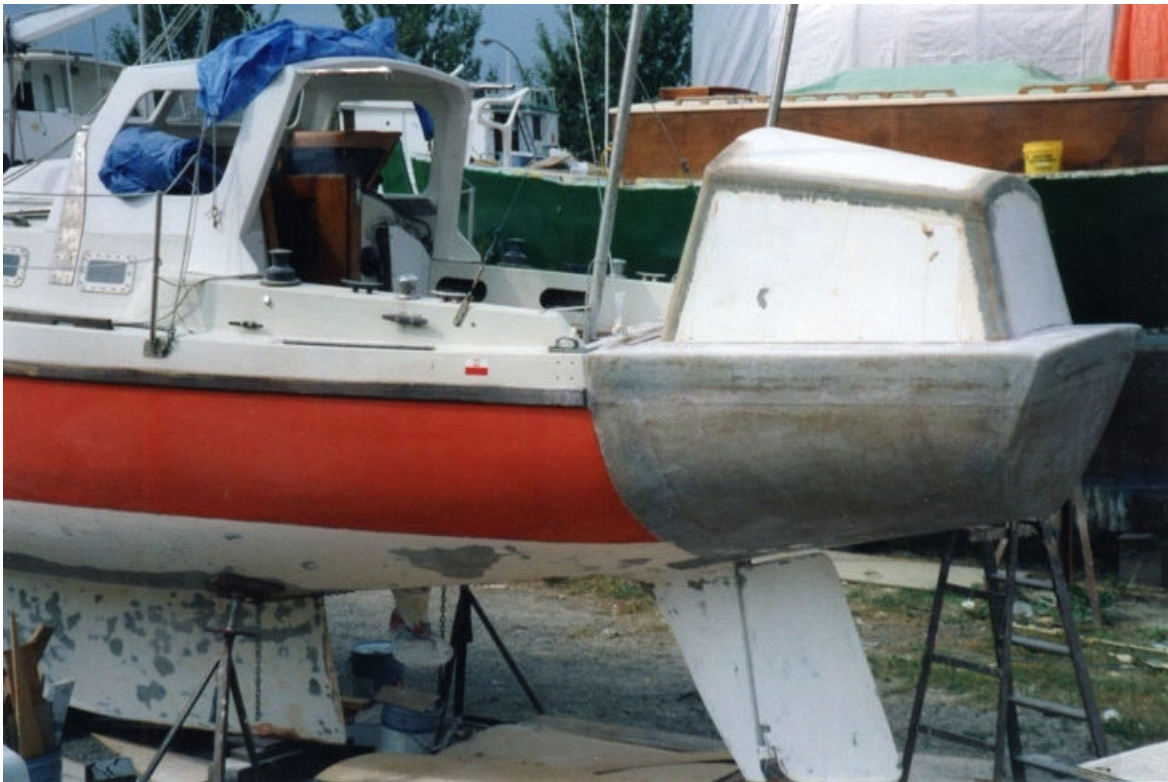
Gotowa nowa sekcja wydłużonej łódki z nadbudówką, surowy FG.
